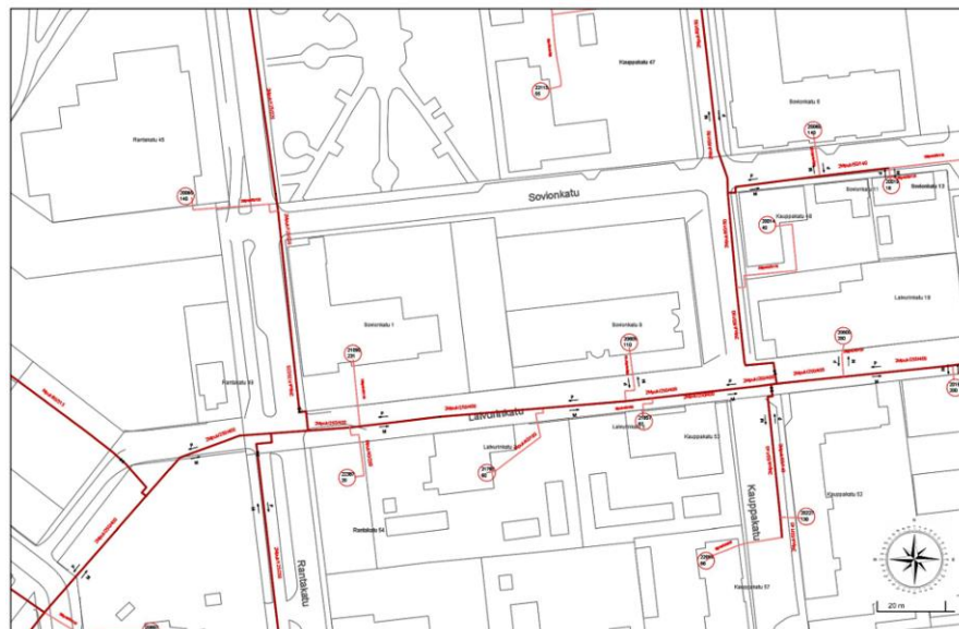
Ote Raahen Energia Oy:n kaukolämpöverkosta, 24.8.2017. Kaukolämpöverkkolinjat sijoittuu Kauppakadun ja Laivurinkadun varteen.
